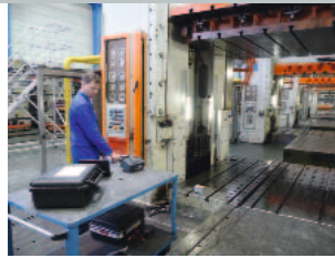
Prüfung einer Pressenstraße bei einem deutschen Automobilzulieferer.
